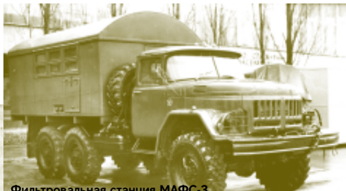
Фильтровальная станция МАФС-3 с кузовом-фургонном КУНГ
