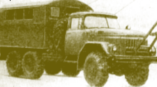
Подвижная танкоремонтная мастерская ТРМ-А-70 с кузовом КМ-157
