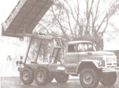
Самосвал на шасси ЗиЛ-131 с предварительным подъемом платформы. Опытный образец
