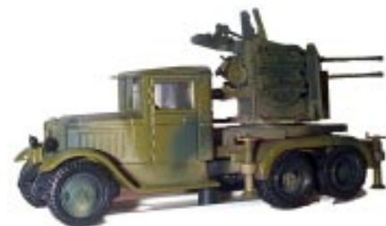
ЗИС-6 с 20-мм счетверенной автоматической зенитной пушкой АА, конверсия (RSM)
