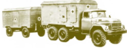
Дезинфекционно-душевая установка ДДА-3 в составе автопоезда
