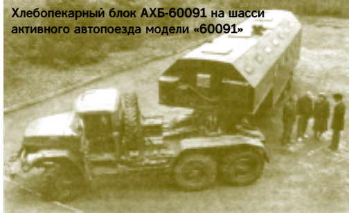
Хлебопекарный блок АХБ-60091 на шасси активного автопоезда модели «60091»
